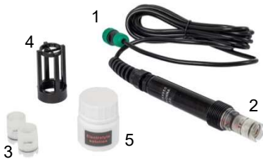
Fig. 74: Sonde O 2 avec connecteur vert (1), set membrane (2), deux sets membrane de remplacement (3), protection antichoc (4) et une solution d'électrolyte (5) (étendue de la livraison)
