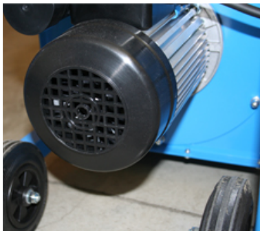
Abb. 4: Motor mit Belüftungsschlitzen
