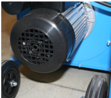
Image 4: Moteur avec fentes d'aération
