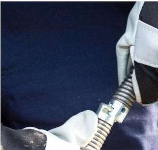
Abb. 8: Schnappverschluss zusammenschieben, um Bohraufsatz zu befestigen
