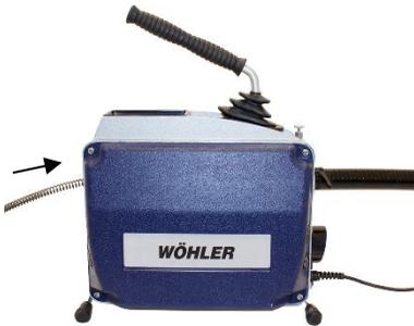
Abb. 11: Verlängerungsspirale von vorne durch das Gerät in den Schutzschlauch schieben.
