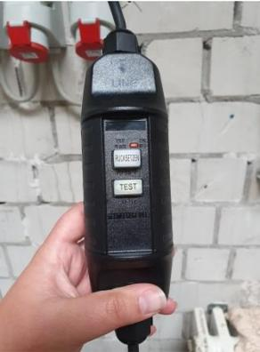
Fig. 6: PRCD-Switch
