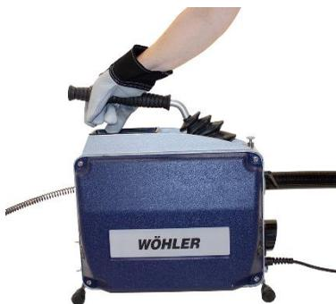
Fig. 20: Levier de commande appuyé: La spirale tourne
