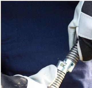
Afb. 8: Kliksluiting ineenschuiven om het boorhulpstuk te bevestigen
