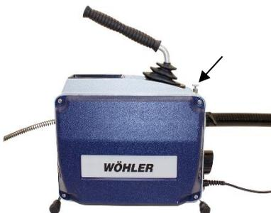
Fig. 5: Le tuyau de guidage fixé sur la spirale, le boulon d'arrêt marqué par une flèche
