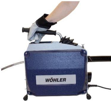
Abb. 5: Bedienhebel nach unten: Spirale dreht
