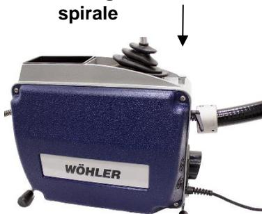
Fig. 24: Détacher le tuyau de guidage
