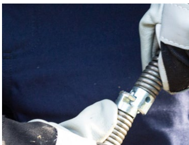
Fig. 6: Resserrer les fermetures à cliquet
