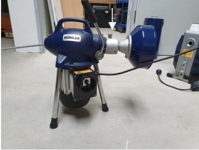
Fig. 11: L'adaptateur fixé à l'appareil, le boulon d'arrêt marqué par une flèche
