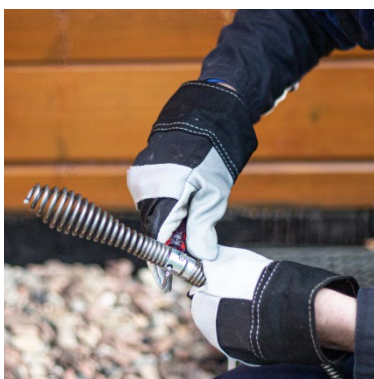
Fig. 7: Desserrer la fermeture à cliquet pour enlever le ressort de la spirale
