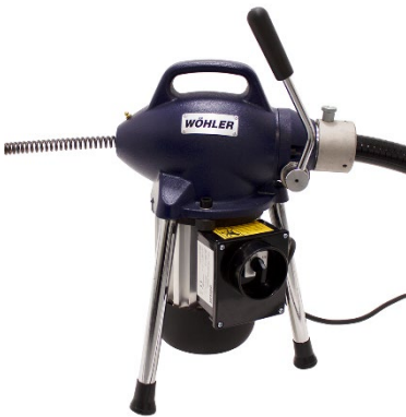
Abb. 4: Spirale durch Schaft geführt, Schutzschlauch bereits aufgezogen.
