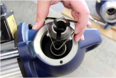
Abb. 16: neue Klemmkupplung einsetzen
