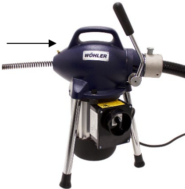
Abb. 10: Verlängerungsspirale von vorne durch das Gerät in den Schutzschlauch schieben.
