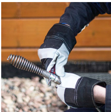
Afb. 7: Kliksluiting losmaken om de boor van de spiraal te verwijderen
