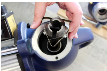
Afb. 16: Nieuwe klemkoppeling inzetten
