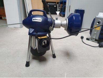
Abb. 11: Adapter am Gerät befestigt, Rastbolzen mit Pfeil gekennzeichnet
