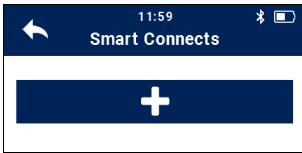
Fig. 8: Connect Wöhler M 603 to Wöhler SC
