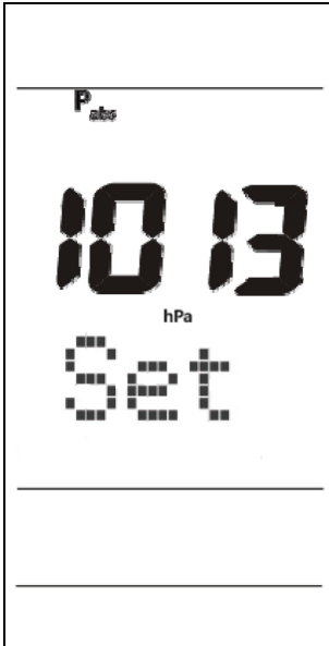
Fig. 15: Default setting „Absolute Pressure“
