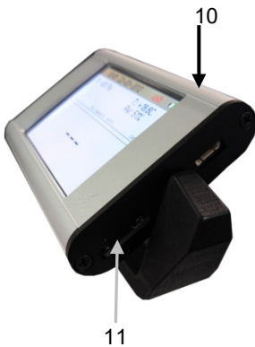
Fig. 47: Moniteur avec slot de carte SD et port USB
