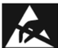
Pri menjavi baterije se izognite elektrostatičnim šokom, saj lahko poškodujete elektronsko vezje termometra!!!!
