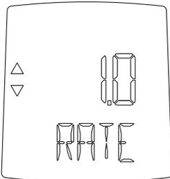
RATE      Messtakt in Sekunden; einstellbar von 1-15 Sekunden; Oberhalb von 15 beginnt die Werteskala wieder bei 1.
