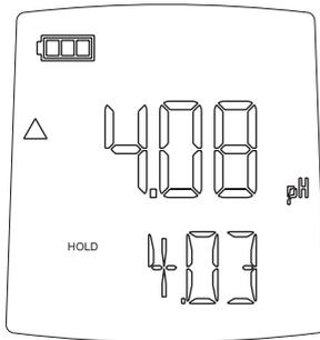
Unter dem aktuellen Messwert erscheint nun eine zweite Anzeigeeile. Darin befindet sich links der Schriftzug HOLD, rechts daneben der festgehaltene pH-Messwert.
